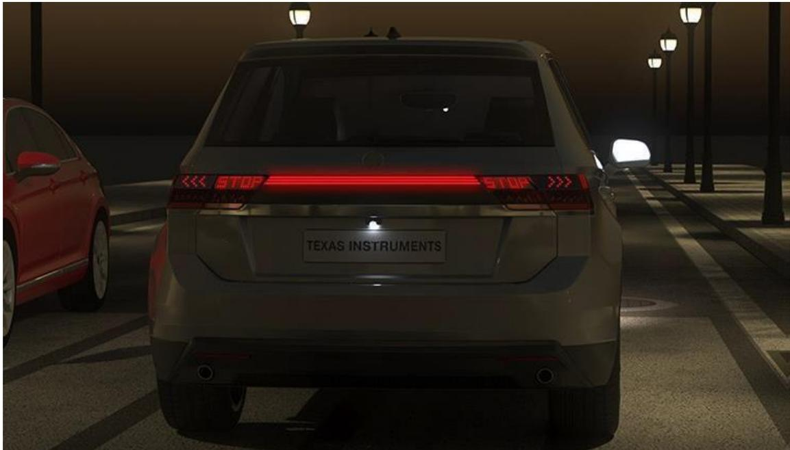
過去尾燈每個燈是獨立控制的，使用的 LED 驅動是數位驅動型的 LED 驅動器，每個燈的元件是單獨驅動。現在需要使整個系統互動，就需要多個畫素，畫素點的數量會增加非常多。這時候 LED 驅動器就從純數位的元件變成了數位 LED 驅動器，內部整合了大量的 PWM 控制，以及內部 LED 量變控制演算法的數位模型。
